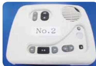
写真2 音声録音図書再生機器
